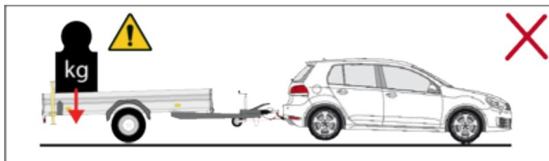
Falsch hinten verteilte Ladung mit der Folge zu geringer Stützlast.
