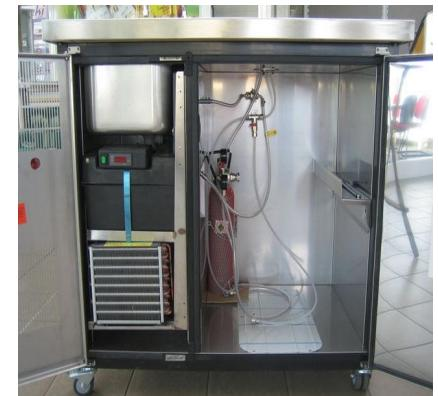
seitlich integrierte Versorgungsanschlüsse für Stromversorgung sowie Wasserzu- und Abwasser.
